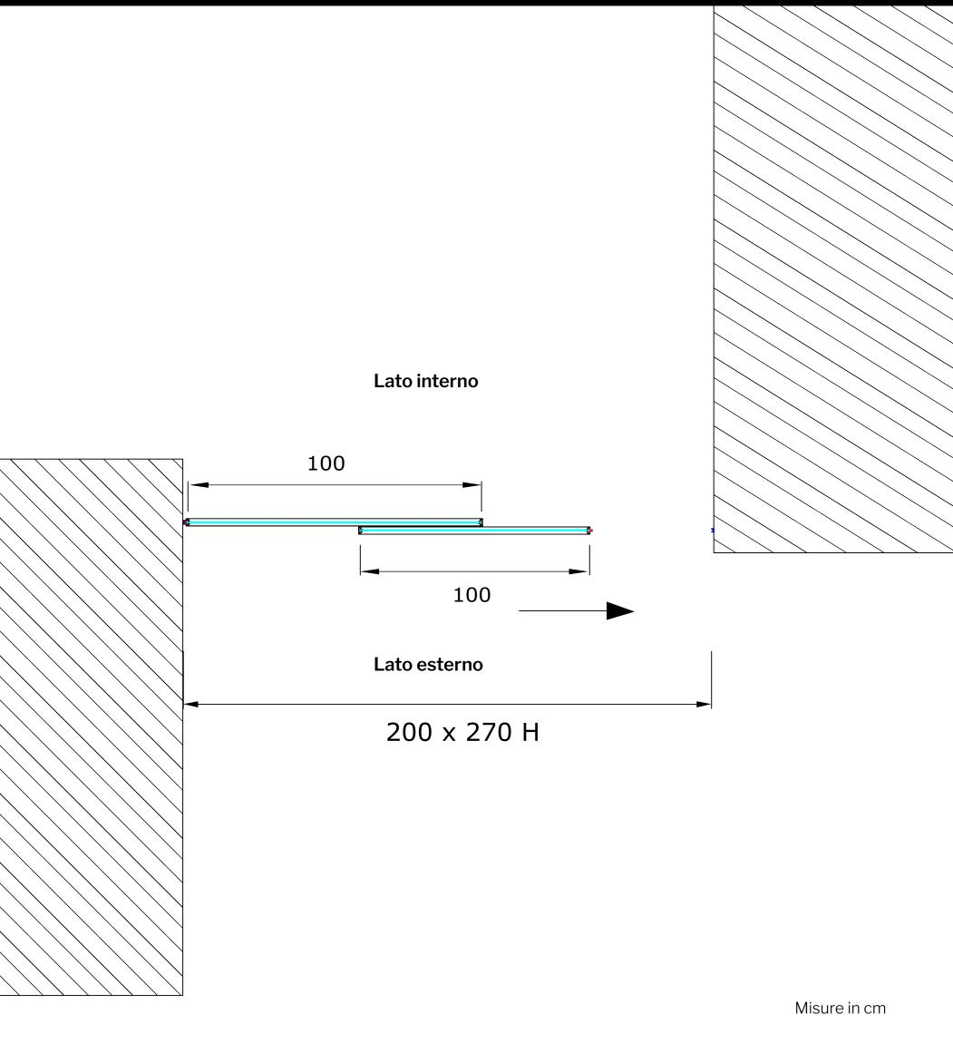
Disposizione in pianta della porta scorrevole esterno muro a 2 ante simmetriche T-ES Design 17
